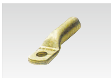
Наконечник силовой без изоляции с удлиненной гильзой Материал- луженая медь Норматив DIN 46235
