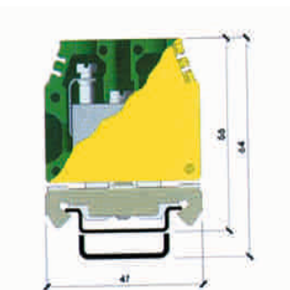
Клемма винтовая для заземления Номинальное сечение - 16 мм 2
